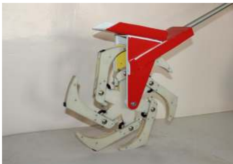
Рисунок 4 – Фотография макета универсального шагающего колеса
