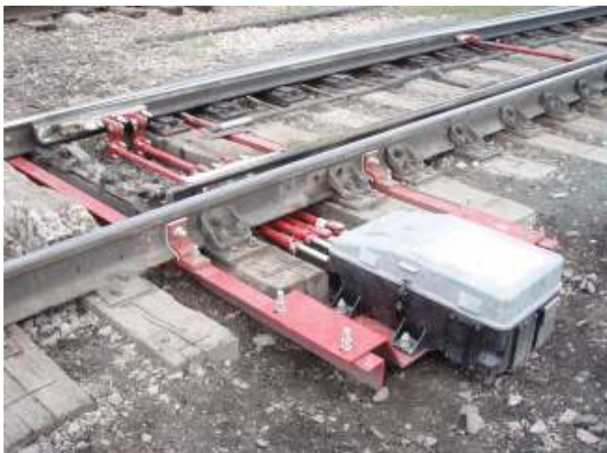
Рисунок 1 – Схема установки стрелочного электропривода типа Р80
