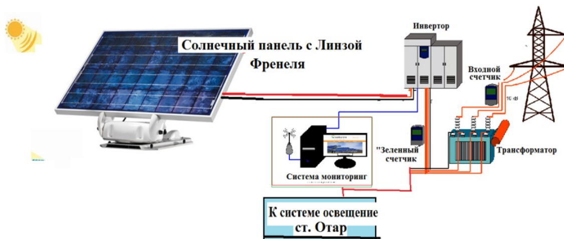
Рисунок 8 – Рекомендуемая солнечная станция с ЛФ мощностью 3 кВт для ст. Отар
